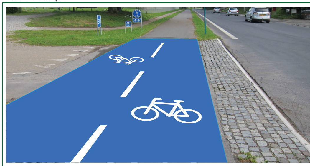
Den dobbeltrettede cykelsti afmærkes med blåt cykelfelt og der er etableres skiltning på sidevejen, der informerer om dobbeltrettet cykeltrafik.
