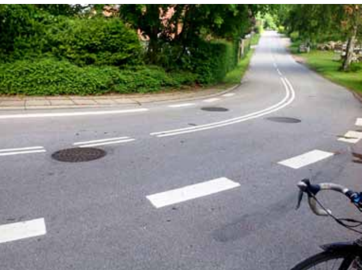
Figur 11. Glatte brønddæksler i sving udgør en særlig fare for cykelryttere.
