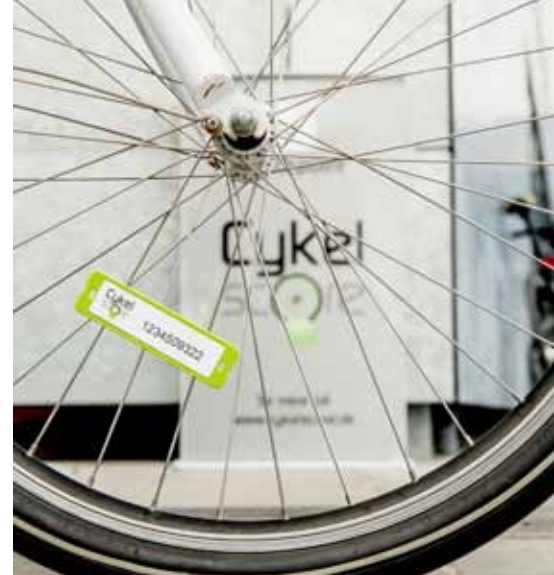
Figur 8. En RFID chip på cyklen sikrer prioritet for cykelrytterne i de signalregulerede kryds i tidsrummet fra kl. 17.00 til 20.00 torsdage.
